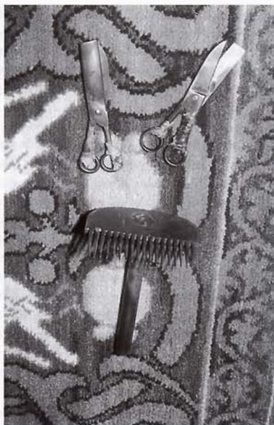
Fot. 11.—Mazo o peine de machacar y tijeras de cortar una vez hecho el nudo
